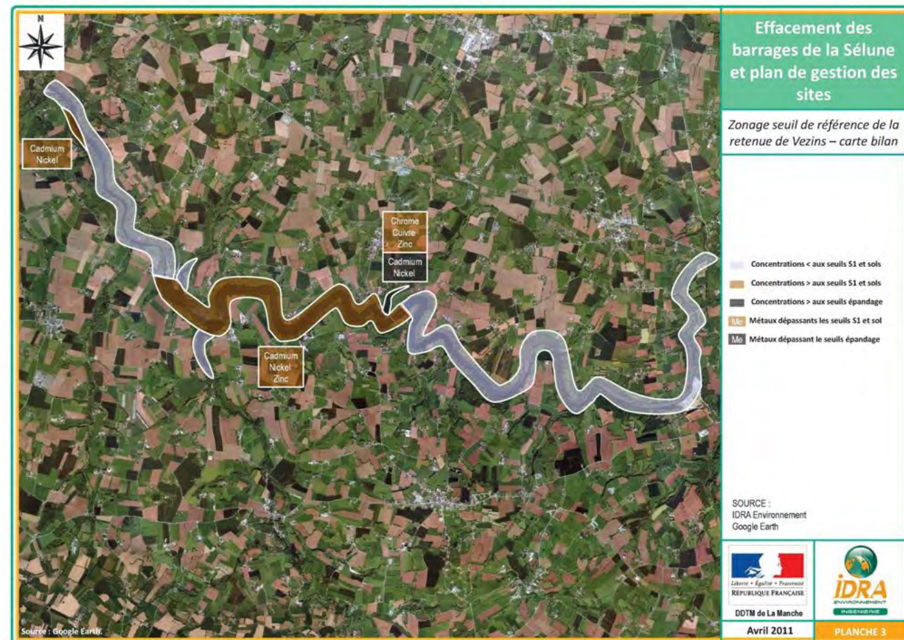
Fig. 42. QUALITE GEOCHIMIQUE DES SEDIMENTS DES BARRAGES - DONNEES IDRA 2011
